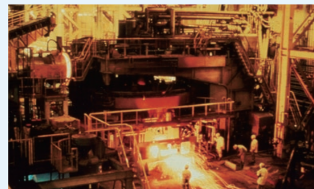
150トン電気炉(1982年)
